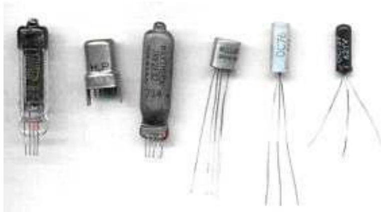
Fig. 2.7 (c) Comparación entre válvulas y transistores
